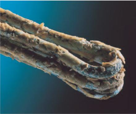
**Kernziele der VDI 2035 sind die Vermeidung von Steinbildung (Blatt 1) und die Vermeidung von wasserseitig verursachten Korrosionsschäden (Blatt 2).**
