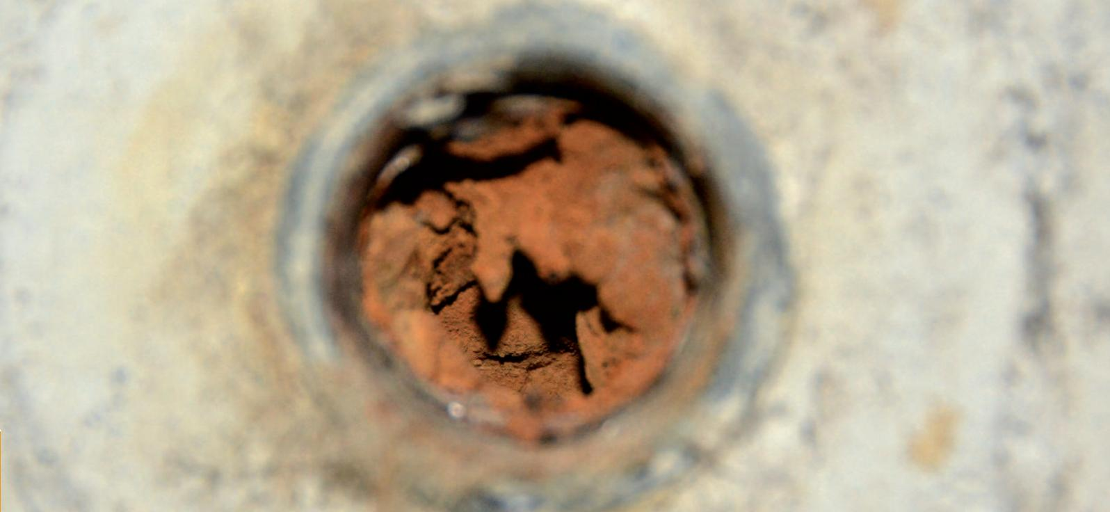
liegen, da saures Wasser Korrosionsvorgänge auslöst und beschleunigt. Es greift die Deckschichten an, die sich auf den Metallen in der Heizungsanlage als natürlicher Korrosionsschutz bilden. Aluminium nimmt dabei eine Sonderstellung ein. Die Deckschichten auf den Aluminiumbauteilen (Wärmetauscher, Heizkörper) können schon ab einem pH-Wert von 8,5 geschädigt werden.
