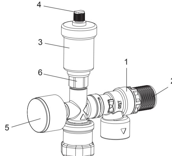
Das Sicherheitsventil (1) kann mittels Drehgriff (2) betätigt werden. Beim Drehen in Pfeilrichtung wird das Ventil geöffnet und wieder geschlossen. Dadurch kann die Funktion des Ventils geprüft und der Ventilsitzbereich durchgespült werden.
