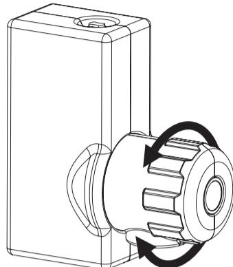
Das Gehäuse ist aus hochwertiger, bleifreier Messing-Legierung, die Federkappe aus Zinkdruckguss gefertigt. Membrane und Dichtungen sind aus hochhitze- und alterungsbeständigem, gummielastischem Kunststoff, die Feder aus korrosionsgeschütztem Federstahldraht gefertigt.
