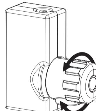
Zawór bezpieczeństwa pełnoskokowy z możliwością ręcznego odpowietrzenia. Obudowa z mosiądu, osłona z GD-Zn, części wewnętrzne z Ms 58, membrana i uszczelka z odpornego na wysoką temperaturę i starzenie tworzywa o elastyczności gumy, sprężyna ze stali sprężynowej, zabezpieczonej galwanicznie przed korozją. Pływak i zawieszenie pływaka z tworzywa sztucznego.
