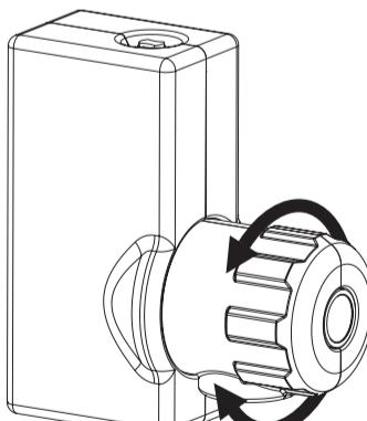
При соединении (седло) мембранный предохранительный клапан отделено от мембраны, сброс производится путём поворота колпачка. Корпус из прессованной латуни. Крышка пружины из GD-Zn, внутренние части из MS 58; мембрана и прокладки из резиноэластичного износостойкого пластика, устойчивого к высоким температурам. Пружина из стальной пружинной проволоки с защитой от коррозии. Поплавок и запасные части из температуроустойчивого пластика.
