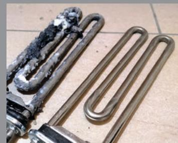
*Kalkablagerungen und Korrosion werden durch die richtige Wasserqualität vermieden.*
