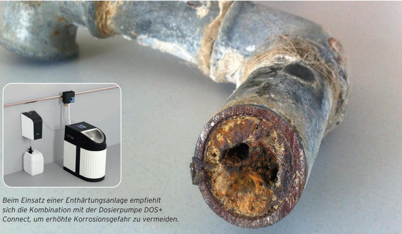
Beim Einsatz einer Enthärtungsanlage empfiehlt sich die Kombination mit der Dosierpumpe DOS+ Connect, um erhöhte Korrosionsgefahr zu vermeiden.
