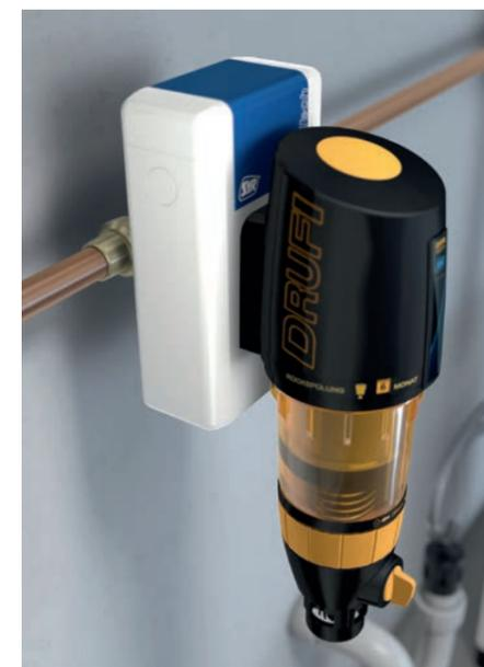
Der SafeTech+ Connect wird direkt hinter dem Wasserzähler auf den SYR Universalflansch montiert. Der DRUFI Trinkwasserfilter kann vorn auf den SafeTech+ geflanscht werden: Fertig ist die kompakte Leckageschutz-/Filtereinheit.
