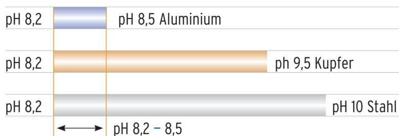
Sind in der Anlage zum Beispiel die drei Werkstoffe Aluminium, Kupfer und Stahl verbaut, sollte der pH-Wert des Heizungswassers zwischen 8,2 und 8,5 liegen. In diesem Bereich überschneiden sich die geschützten Bereiche der drei Werkstoffe – somit kann keine Korrosion entstehen.
