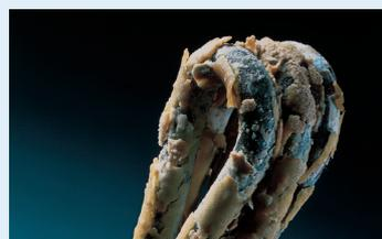
Kalkablagerungen und Korrosion werden durch die richtige Wasserqualität vermieden.
