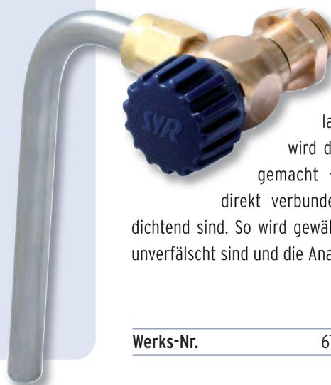
Und die Entnahme von Trinkwasserproben geht denkbar einfach: Das lange Auslauffröhrchen aus Edelstahl wird durch Beflammen keimfrei gemacht - kein Problem, da die direkt verbundenen Bauteile metallisch dichtend sind. So wird gewährleistet, dass die Proben unverfälscht sind und die Analyse fehlerfrei bleibt.
