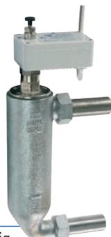
Die Wassermangelsicherungen von SYR sichern Heizkessel zuverlässig gegen Schäden durch Wassermangel. Der Einbau einer solchen Wassermangelsicherung ist bei Heizkesseln in Warmwasser-Heizungsanlagen mit einer Leistung von über 300 kW nach DIN EN 12828 vorgeschrieben. Bei einer geringeren Heizleistung der Anlage muss gewährleistet sein, dass durch Wassermangel keine Aufheizung auftreten kann.
