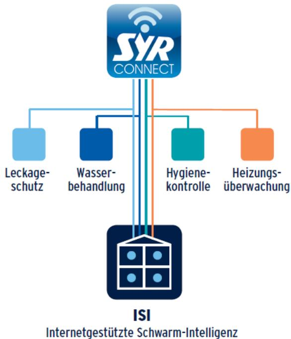
Mit SYR Connect kontrolliert der Nutzer seine Leckageschutzarmaturen Safe-T Connect oder ISI bequem von unterwegs. Gleichzeitig werden auch andere Felder – und damit Armaturen – mit der Technologie bedienbar und gesteuert werden können.
