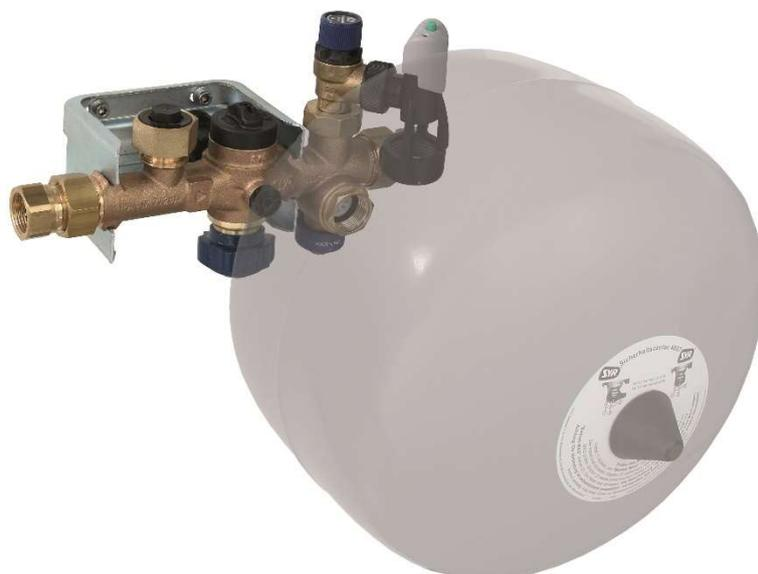
Das SicherheitsCenter 4807 von SYR ist zur normgerechten Absicherung geschlossener Trinkwassererwärmer konzipiert: Doppelabspernung, Rückflussverhinderer, Membran-Sicherheitsventil und Durchströmungsarmatur mit Wartungsabspernung sind ebenso vorhanden wie ein durchströmtes MAG und ein Anschluss für einen zusätzlichen Kaltwasserverbraucher.
