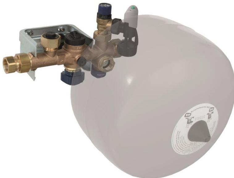
Das SicherheitsCenter 4807 von SYR ist zur normgerechten Absicherung geschlossener Trinkwassererwärmer konzipiert: Doppelabspernung, Rückflussverhinderer, Membran-Sicherheitsventil und Durchströmungsarmatur mit Wartungsabspernung sind ebenso an Bord, wie ein durchströmtes MAG und ein Anschluss für einen zusätzlichen Kaltwasserverbraucher.
