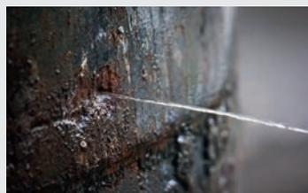
Kleines Loch mit großen Folgen – beispielsweise in alten Trinkwassererwärmern.
