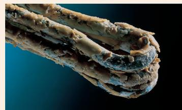
Weiches Wasser schützt die Installation vor Kalkablagerungen und spart Energie.
