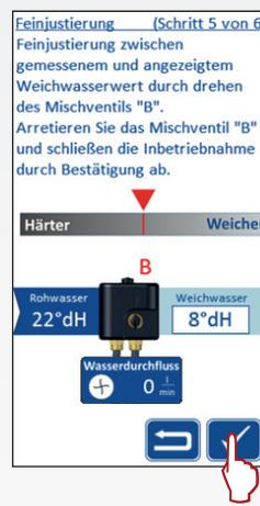
10. Messen Sie mit Hilfe des Härtemessbestecks die Weichwasserhärte an einer beliebigen Zapfstelle und regeln Sie ggfs. am Verschneideventil „B“ nach, bis Ihre Wunschhärte erreicht ist.
