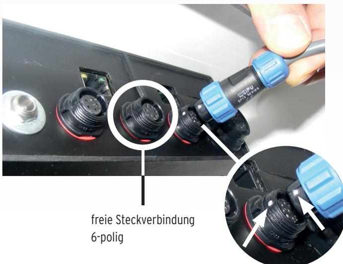
8. Verbinden Sie anschließend die folgenden elektrischen Kabelanschlüsse des Steuerkopfes mit der Steuerung auf der Rückseite der Gerätehaube (Beginnen Sie mit dem 12-poligen Stecker).
