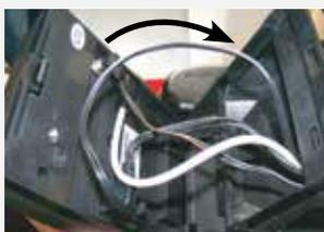
12. Montieren Sie die LEX Connect Steuerung durch Einclipsen an den Sockel des Steuerkopfes der Mastersäule (A). Montieren Sie die Abdeckhauben der Steuerköpfe.
