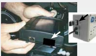
11. Entfernen Sie den schwarzen Aufkleber. Verbinden Sie nun das CAN-Bus Kabel mit der LEX Connect Steuerung und der Steuerbox an den dafür vorgesehenen Steckplätzen. Bitte führen Sie das Netzkabel LEX Connect Steuerung durch die Aussparung der Master-Säule A. Das Netzkabel kann jetzt mit der Steuerbox verbunden werden.
