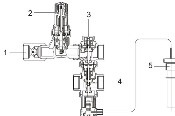
**Einbau und Funktion:** Die Sicherheitseinrichtung beinhaltet, in Fließrichtung, die folgenden Bauelemente: Rückflußverhinderer (1), Druckminderer (2), thermisch gesteuertes Eingangsventil (öffnet 92°C, schließt 87°C) (3), thermisch gesteuertes Ausgangsventil (öffnet 99°C, schließt 94°C) (4), Temperaturfühler (5).
