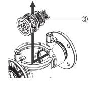
Drehen Sie das Werkzeug um 180°. Demontieren Sie den Ausgangsrückflussverhinderer (3) mit Hilfe des Werkzeugs.
