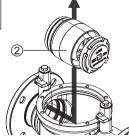
Demontieren Sie den Eingangsrückflussverhinderer (2) mit Hilfe des Werkzeugs 6600.65.904.
