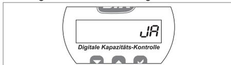
Drücken Sie die - oder -Taste, um den Kartuschenwechsel zu bestätigen (Ja) oder abzulehnen (Nein).
