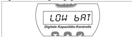
Um die Batterie zu tauschen, schrauben Sie den Deckel ab und ersetzen Sie die Batterie (CR-2032). **Achten Sie auf die richtige Polarität!**
