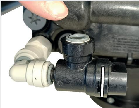
Achten Sie darauf, dass die neue Version der Chlorzelle komplett und waagrecht in dem John-Guest-Winkel steckt und montieren Sie den zweiten John-Guest-Winkel.
