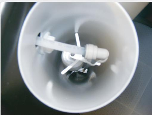
Lösen Sie die Soleleitung im Salzbehälter, indem Sie mit zwei Fingern den grauen Ring des John-Guest-Winkels eindrücken und mit der anderen Hand die Soleleitung abziehen.
