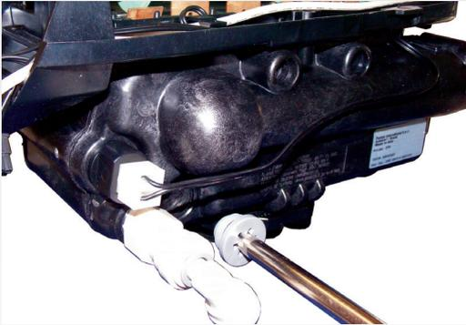
Drehen Sie mit einem Torx-Schlüssel (T 50) den Verschlussstopfen (4 - Seite 15) des Injektors gegen den Uhrzeigersinn heraus.
