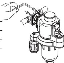
**Das druckdichte Anziehen der Innensechskantschrauben muß über Kreuz erfolgen!** Der Ablauftrichter ist bei Bedarf auf die Schlauchtülle zu schrauben.
