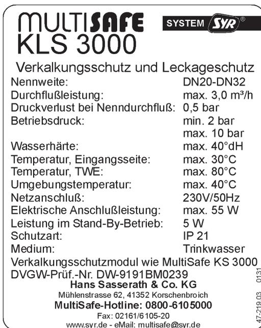
Das Typenschild (Abb. 1) ist am Gerät sichtbar angebracht.
