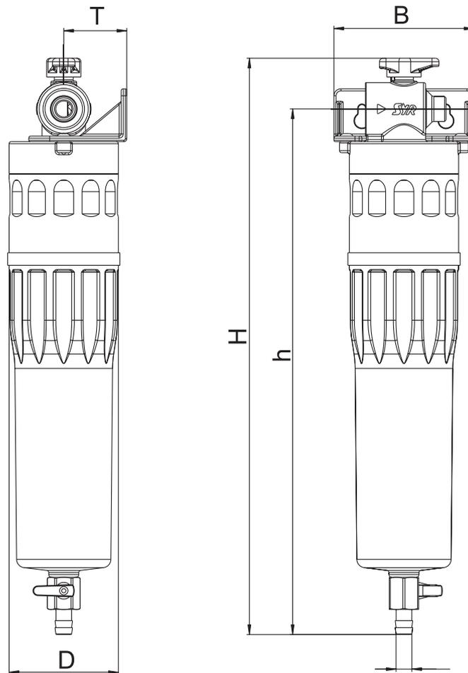
Mindestabstand des Kugelhahns zum Boden von ca. 10 cm zu Wartungszwecken beachten!
