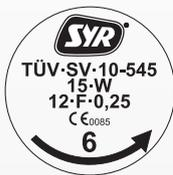
Jedes Membran-Sicherheitsventil muss dauerhaft gekennzeichnet sein mit Herstellerkennzeichen, TÜV-Prüfnummer, Nennweite (mit dem Kennbuchstaben W für Trinkwasser) und dem Einstelldruck. Das Bild links zeigt ein typisches Beispiel für eine Kennzeichnungs-Plakette.
