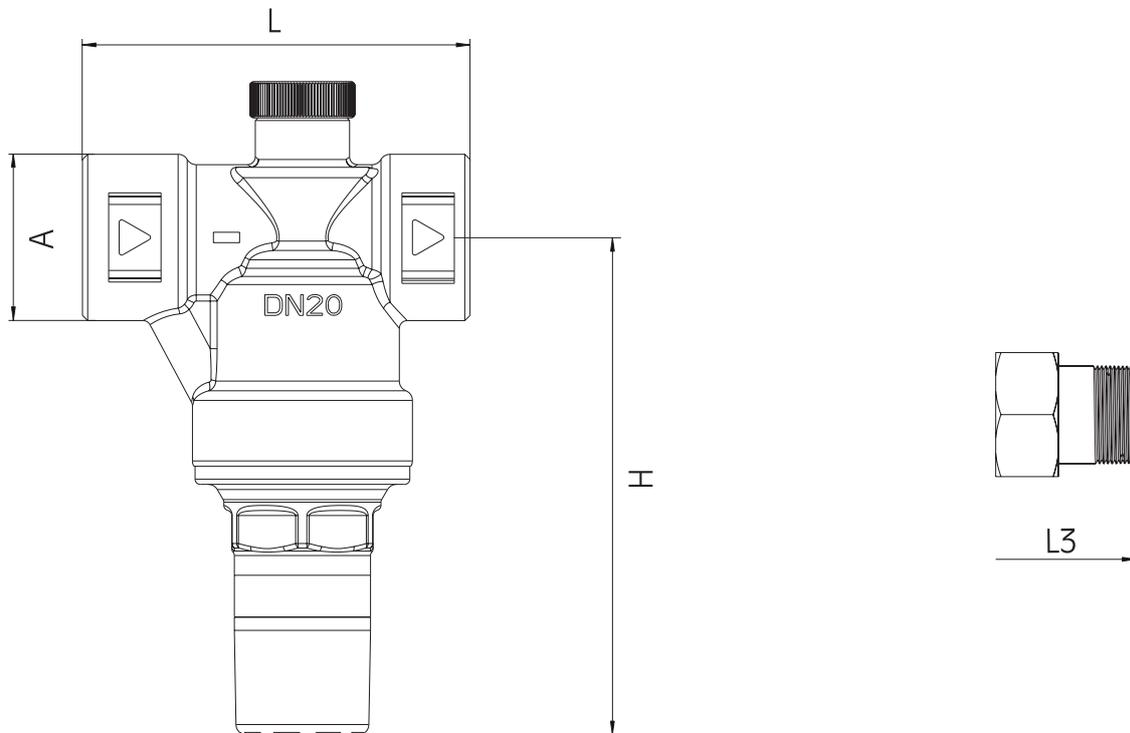
Außengewinde, Klemmring- und Tectite-Verschraubungen 15 und 22 mm optional für die Anschlüsse DN 15 und DN 20 erhältlich.
