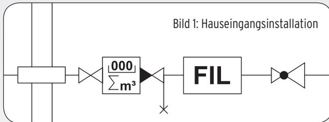
Nach Überarbeitung der DIN 1988, Teil 200 muss in alle Trinkwasserinstallationen vor Inbetriebnahme ein Filter nach DIN EN 13443-1 eingebaut werden. Es ist unvermeidbar, dass mit dem angelieferten Trinkwasser kleine Feststoffpartikel, wie z.B. Rostteilchen und Sandkörner, in die Hausinstallation eingespült werden. Diese Teilchen sind von der Rohrwand losgelöste Korrosionsprodukte und Inkrustationen
